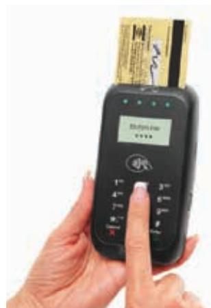
Uz Casio IT-9000 odvojeno dolazi uređaj Verifone e255 povezan sa mobilnim uređajem Bluetooth tehnologijom, a korist će za procesiranje bezgotovinskog plaćanja, podržavajući sve vrste bankovnih kartica.
